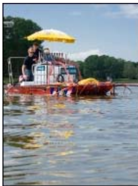
Figuur 6: doseerinstallatie van H_2O_2 op boot
