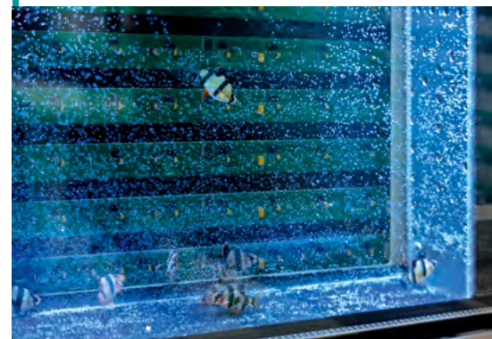
El ToxProtect II monitoriza la actividad de natación de los peces en un acuario alimentado con agua potable o agua de cañerías.
