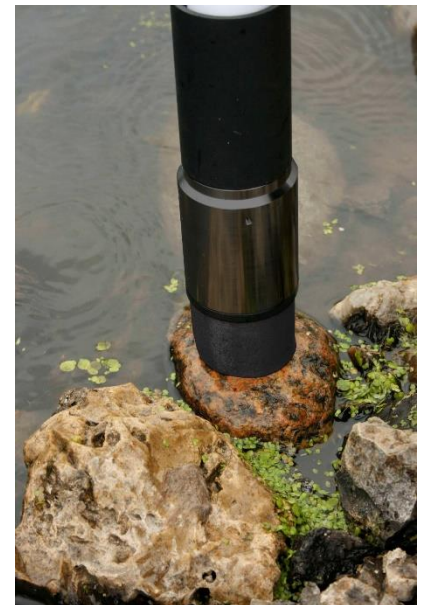
bbe BenthoTorch: para la medición de clorofila-a en diferentes sustratos
